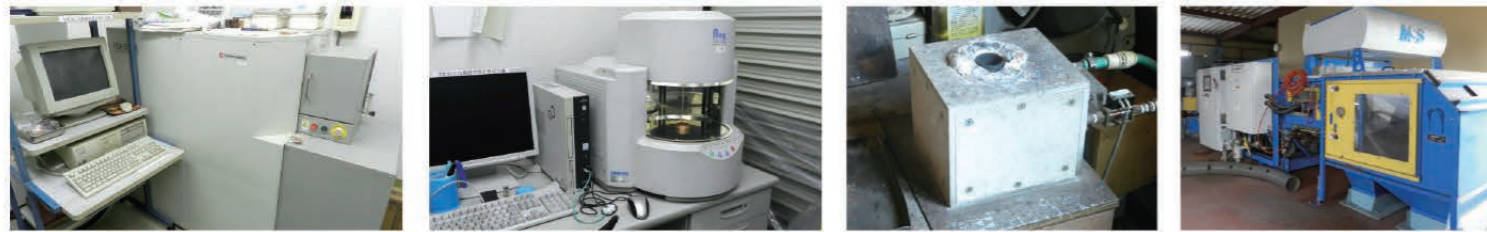
●発光分析機 ●X線分析機 ●試験片溶解炉 ●メタルソーター
